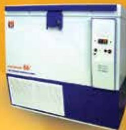
دیپ فریزر صندوقی -۸۰- درجه سانتی گراد Ultra low temperature freezer (chest -80 °c)
